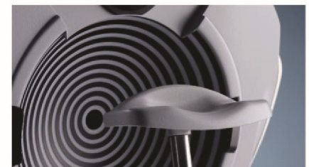
Кольца Пласидо -Измерение радиуса кривизны роговицы
